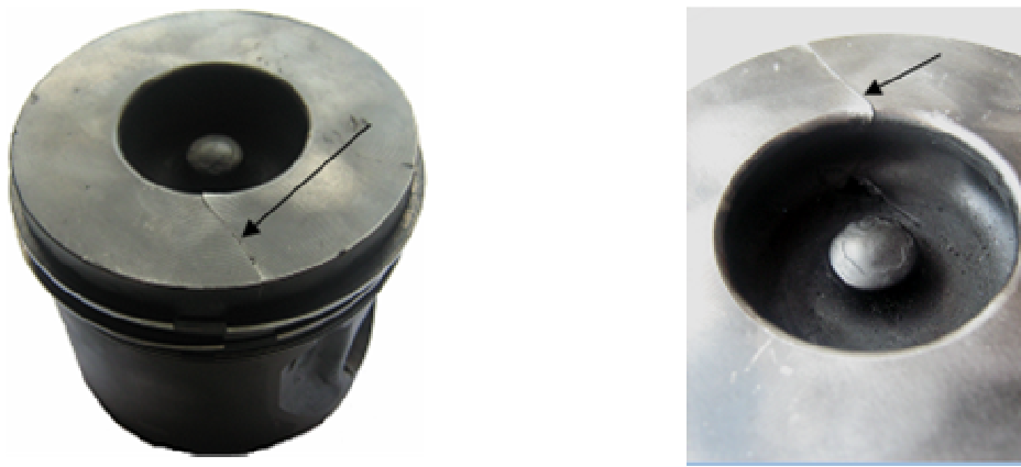
Rys. 3. Denko tłoka z widocznym pęknięciem oraz wykruszeniem w komorze spalania
