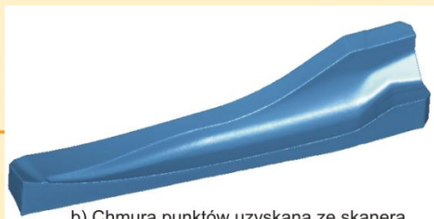
b) Chmura punktów uzyskana ze skanera
