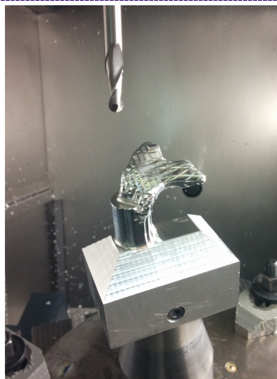
Wykonanie modelu kości jarzmowej
