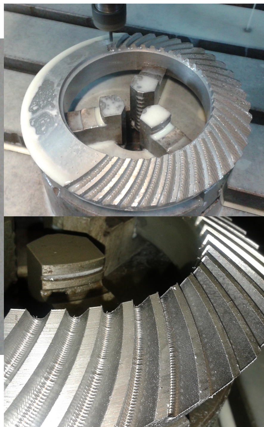
Wynik eksperymentalnej obróbki wykonanej na 3-osiowym centrum frezarskim Avia VMC650 w stali 40H
