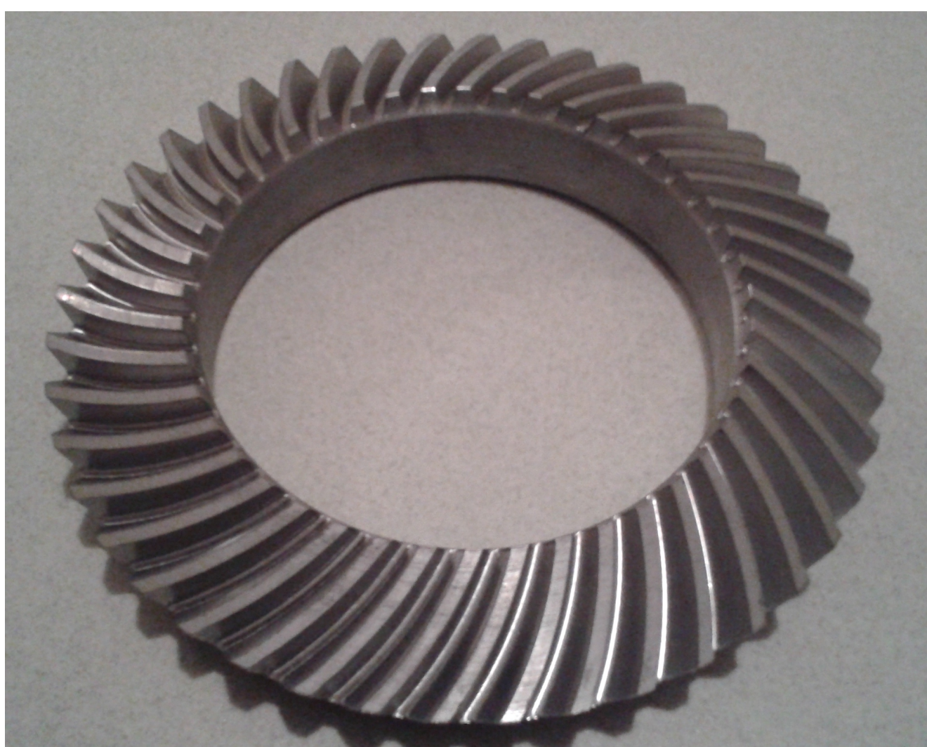
Wynik eksperymentalnej obróbki wykonanej na 3-osiowym centrum frezarskim Avia VMC650 w stali 40H
