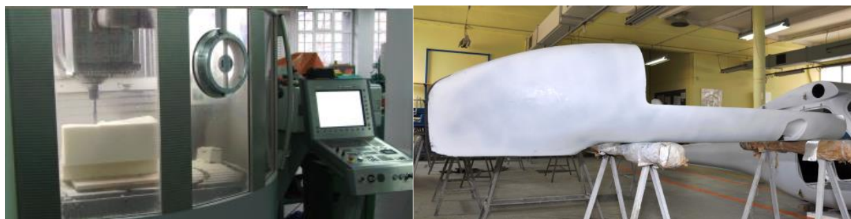
Rys. 11. Proces wytwarzania kompozytowego kadłuba pojazdu
