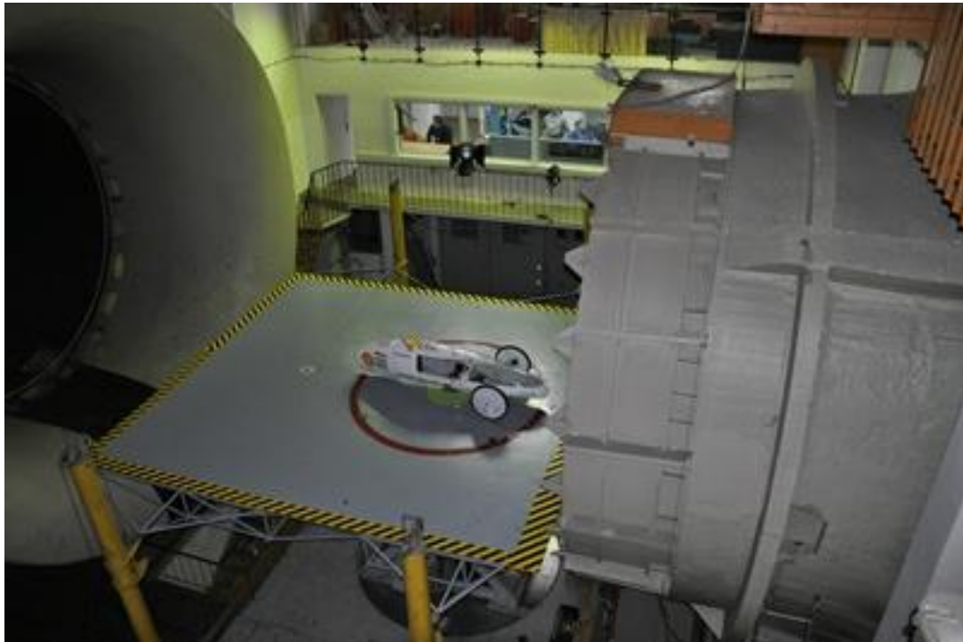
Rys. 8. Badanie cech aerodynamicznych bolidu w tunelu aerodynamicznym w Instytucie Lotnictwa w Warszawie
