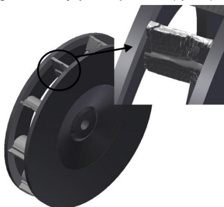
Rys. 7 Model CAD koła bijakowego ze zużytymi bijakami
