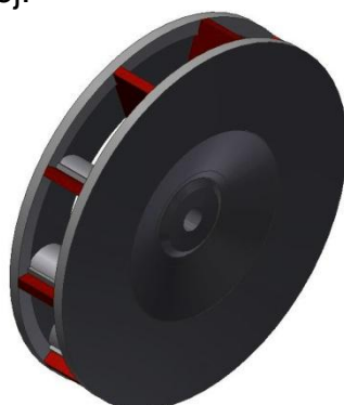
Rys. 3 Model koła bijakowego o nominalnym kształcie
