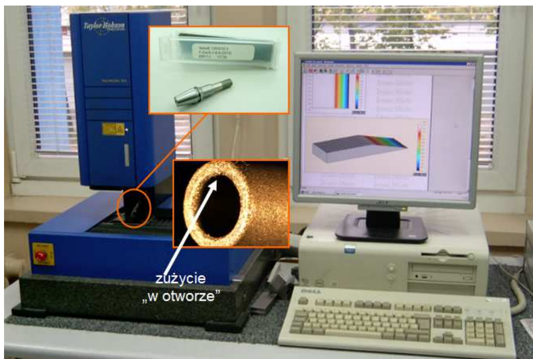
Rys. 4. Laserowy pomiar zużycia powierzchni wewnętrznej ściernicy z zastosowaniem profilometru 3D TALYSCAN 150 firmy Taylor Hobson i programów TalyMap Expert i Mountains Map Universal
