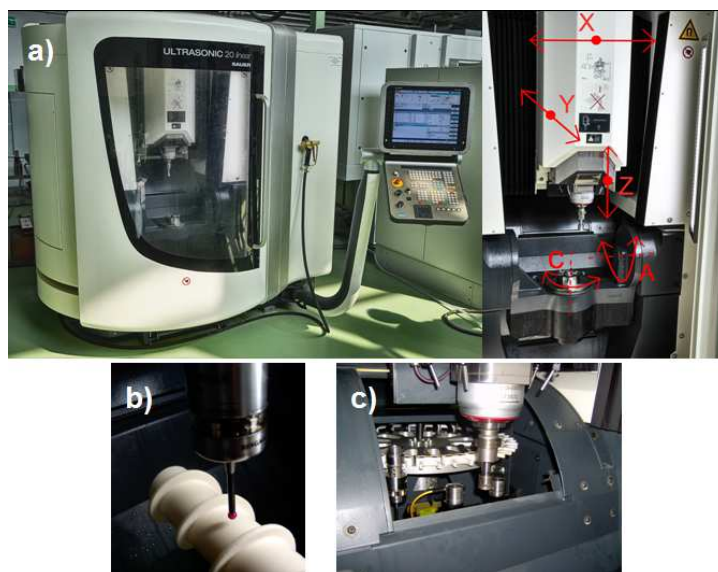
Rys. 14. Stanowisko badawcze Ultrasonic 20 linear: widok ogólny oraz układ osi sterowanych (a), zastosowanie głowicy do pomiaru przedmiotu (b), zastosowanie bramki laserowej do badań zużycia ściernic (c)
