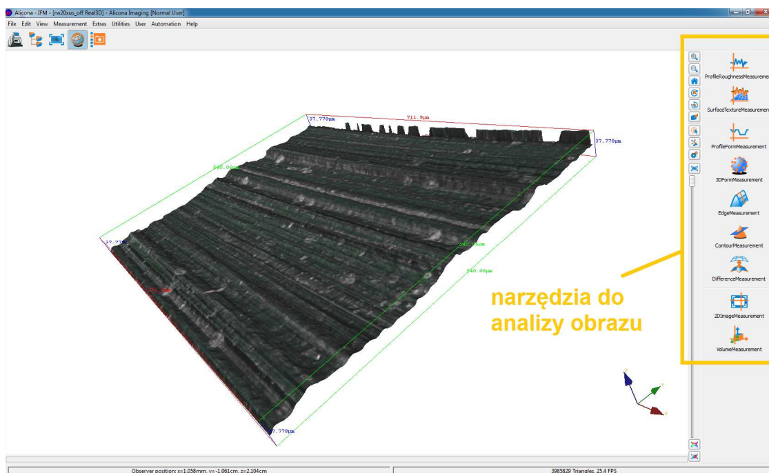
Rys. 6. Badanie amplitudy oscylacji ściernicy z zastosowaniem analizy obrazu śladów ziaren ściernych na przedmiocie wykonanym ze stali (narzędzia do analizy obrazu oprogramowania mikroskopu InfiniteFocus Real 3D Alicona)
