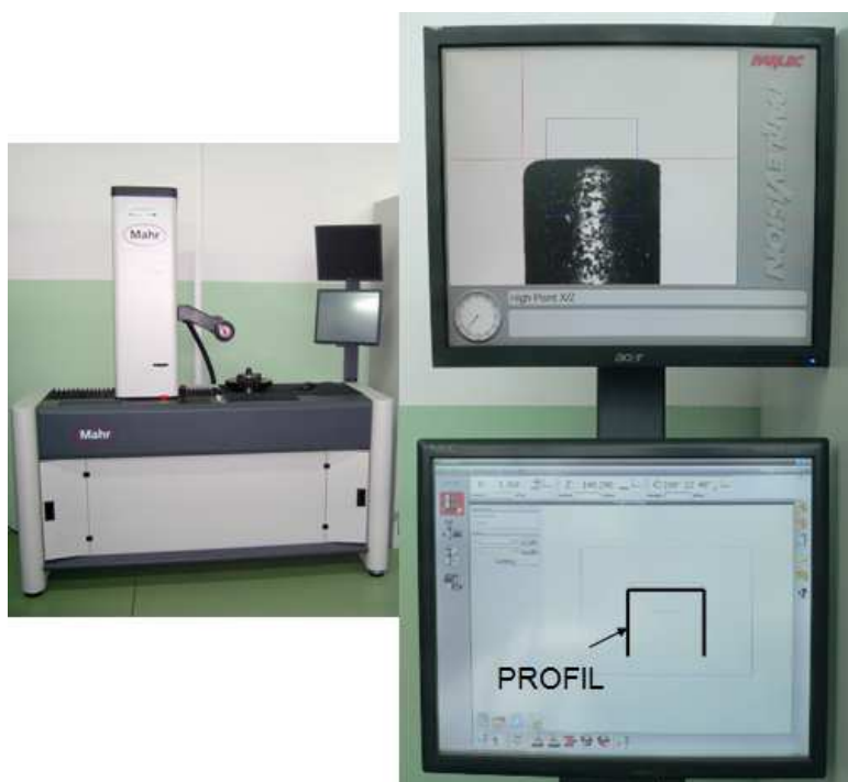
Rys. 5. Analiza profilu zewnętrznego ściernicy z zastosowaniem ustawiaaka sterowanego numerycznie (program PARLEC PARLEVISION PGC PLUS 6)
