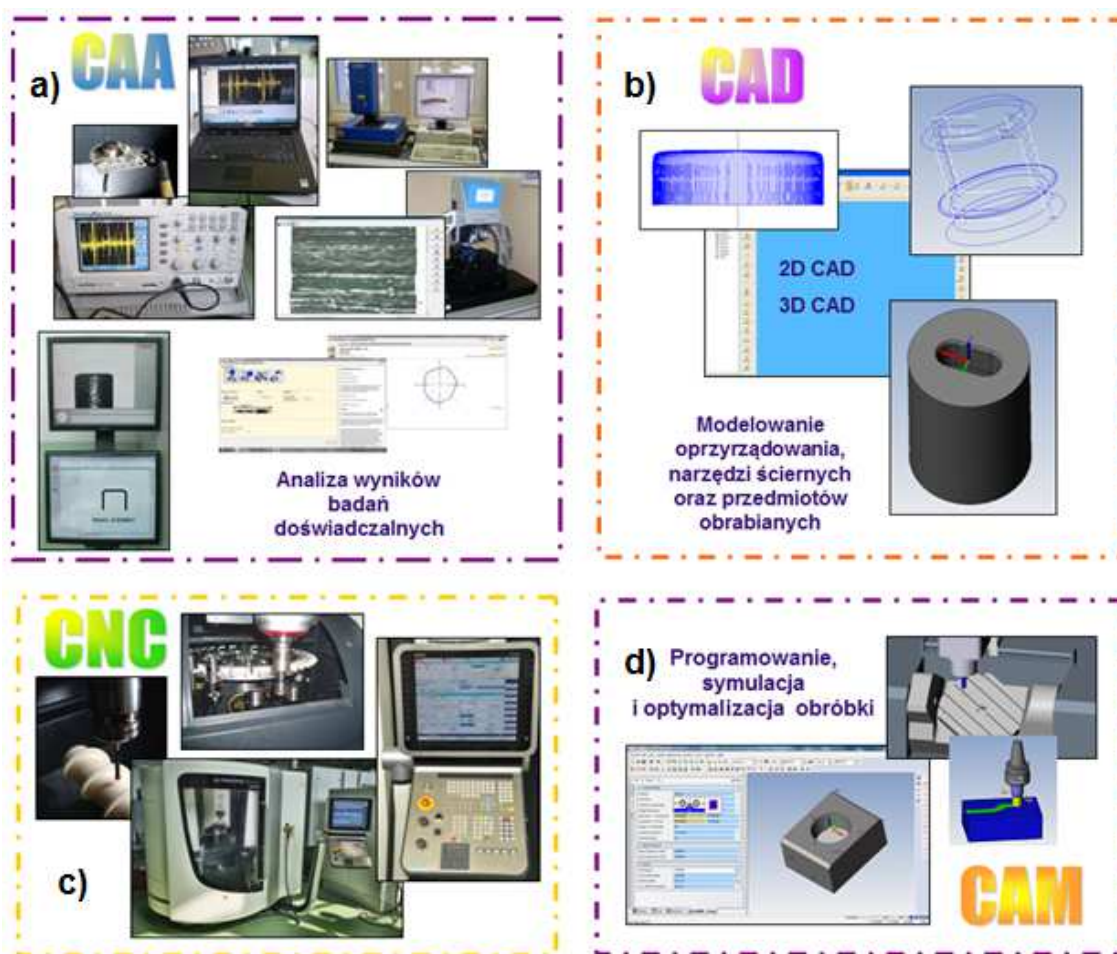
Rys. 2. Wybrane grupy narzędzi CAx wspomagających badania procesu UAG: a) narzędzia CAA ( Computer Aided Analysis ): komputerowe wspomaganie analiz, b) narzędzia CAD ( Computer Aided Design ): komputerowe wspomaganie projektowania oprzyrządowania, narzędzi ściernych oraz przedmiotów obrabianych, c) obrabiarki sterowane numerycznie CNC ( Computer Numerical Control ): realizacja procesu obróbki oraz pomiaru narzędzi i przedmiotów obrabianych, d) narzędzia CAM ( Computer Aided Manufacturing ): automatyczne opracowywanie programów sterujących, symulacja i optymalizacja obróbki
