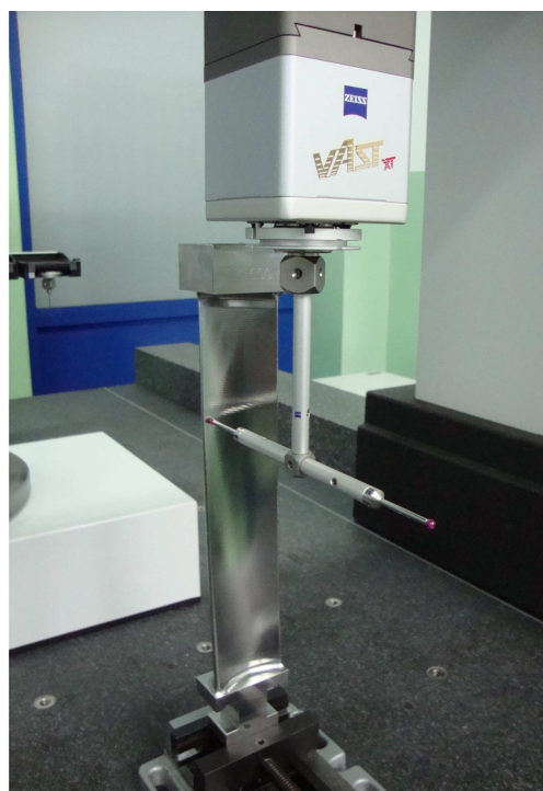
Rys. 1. Współrzędnościowa maszyna pomiarowa ACCURA II i głowica pomiarowa VAST XT
