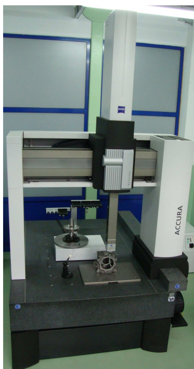
Rys. 1. Współrzędnościowa maszyna pomiarowa ACCURA II i głowica pomiarowa VAST XT
