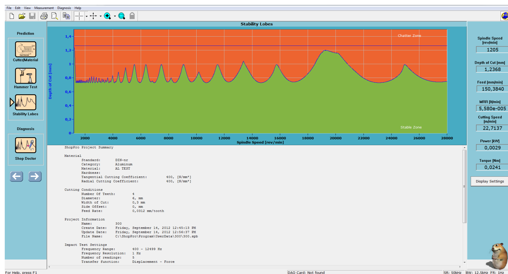
Wykres stabilności procesu frezowania (ShopPro)
