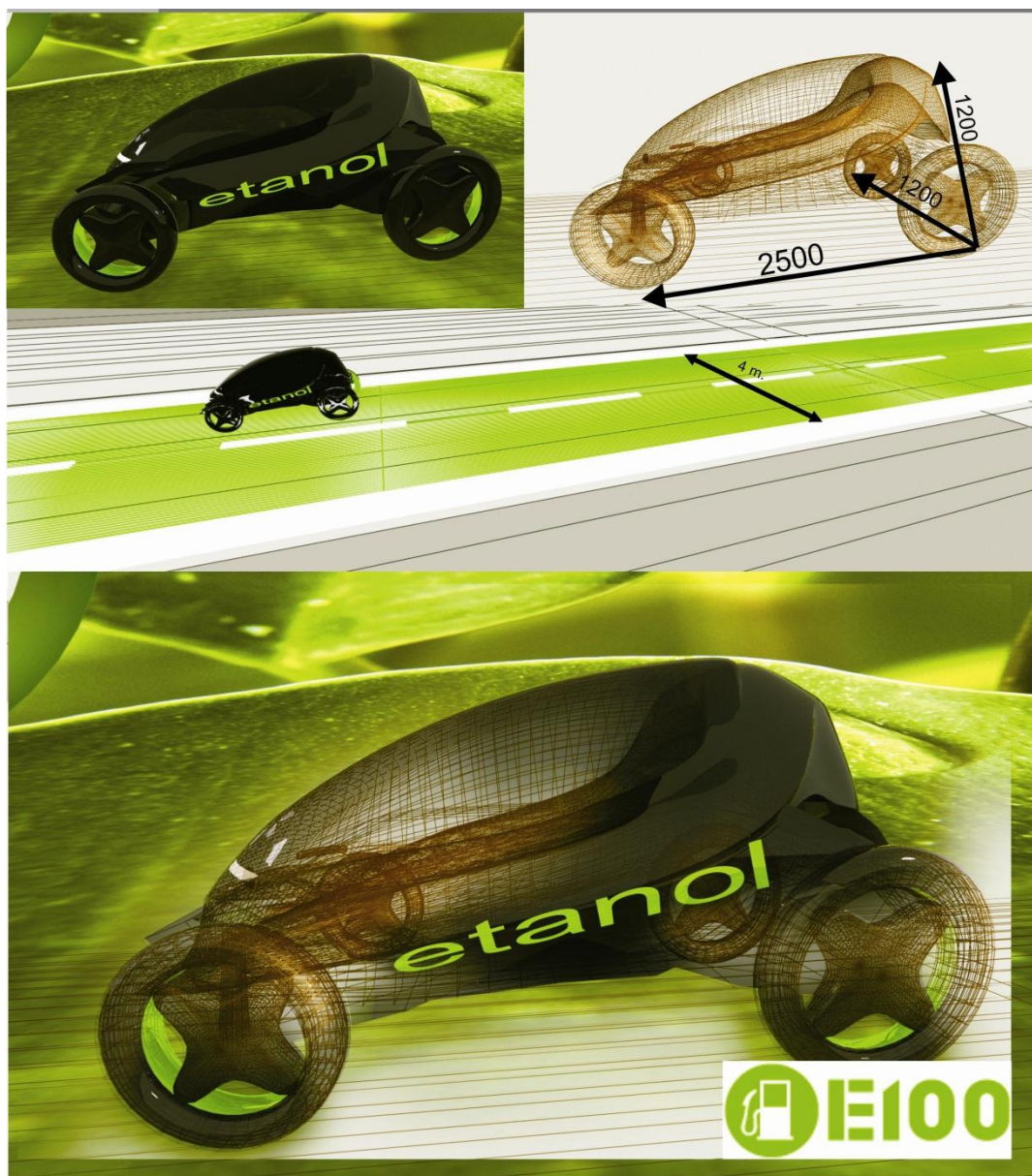
Rys. 2. Widok ogólny pojazdu ekologicznego z podstawowymi założeniami wymiarowo konstrukcyjnymi (opracowanie student Wojciech Reszeta)
