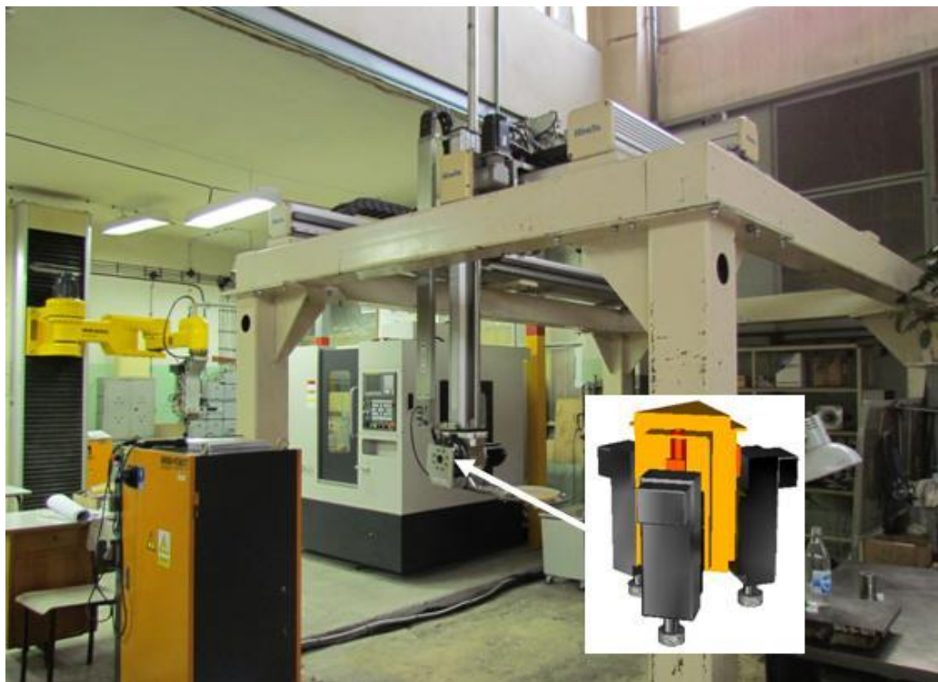
Rys. 1. Głowica szlifierska z pneumatyczną kompensacją siły docisku dla poszczególnych narzędzi szlifierskich osadzonych w elektrowrzecionach
