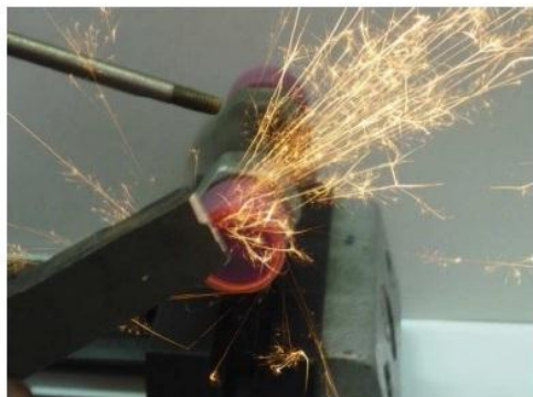
Rys. 26. Widok procesu szlifowania próbki wykonanej ze stali 40H(54±2HRC): a) czołowego, b) obwodowego
