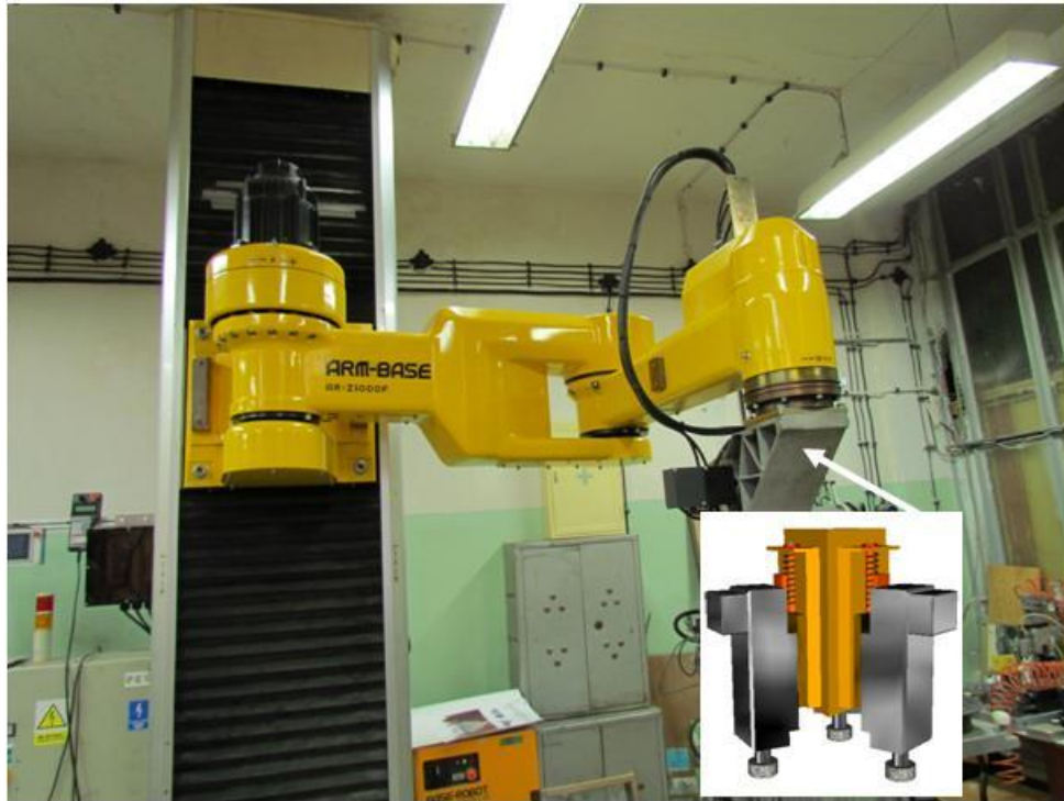
Rys. 2. Trójwrzecionowa głowica szlifierska z mechanicznym systemem kompensacji dosuwu z zastosowaniem amortyzatora sprężynowego
