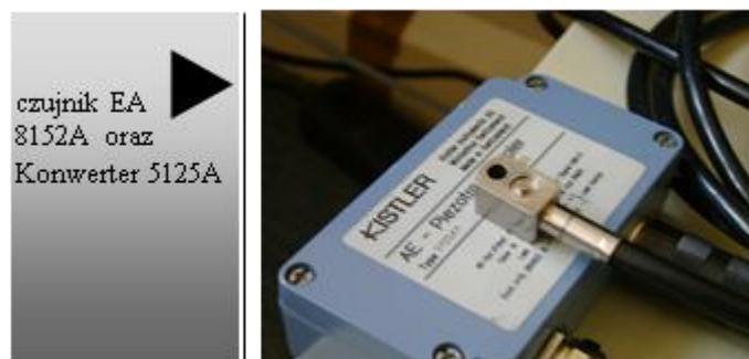
Rys. 10. Zastosowanie czujnika EA na stanowisku badawczym (czujnik umieszczono bezpośrednio na elemencie obrabianym w celu minimalizacji zakłóceń sygnału EA), (widok ogólny czujnika piezoelektrycznego typu 8152A)
