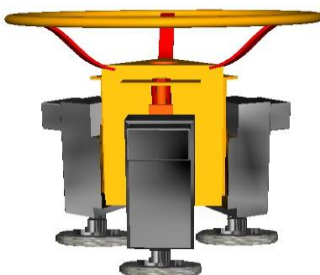
Rys. 14. Przykładowa konstrukcja do obróbki powierzchni swobodnych i płaskich dla ręcznego prowadzenia głowicy
