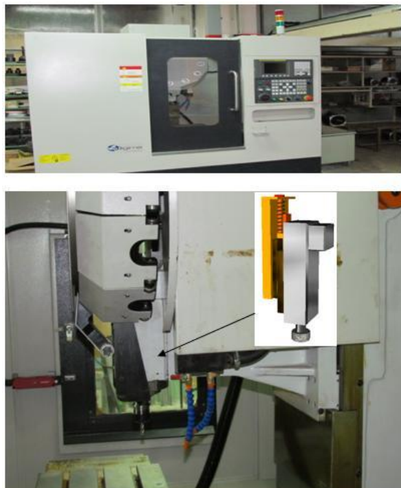
Rys. 13. Projekt głowicy obróbkowej do wygładzania powierzchni krzywoliniowych na centrum trzyosiowym frezarskim z zastosowaniem zespołu dosuwu piezoelektrycznego
