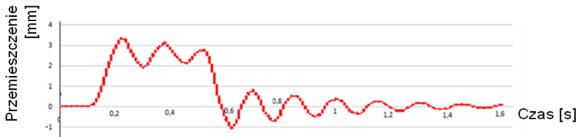
Rys. 8. Zmiana przemieszczeń pionowych dla węzła środkowego w połowie długości wagonu w funkcji czasu
