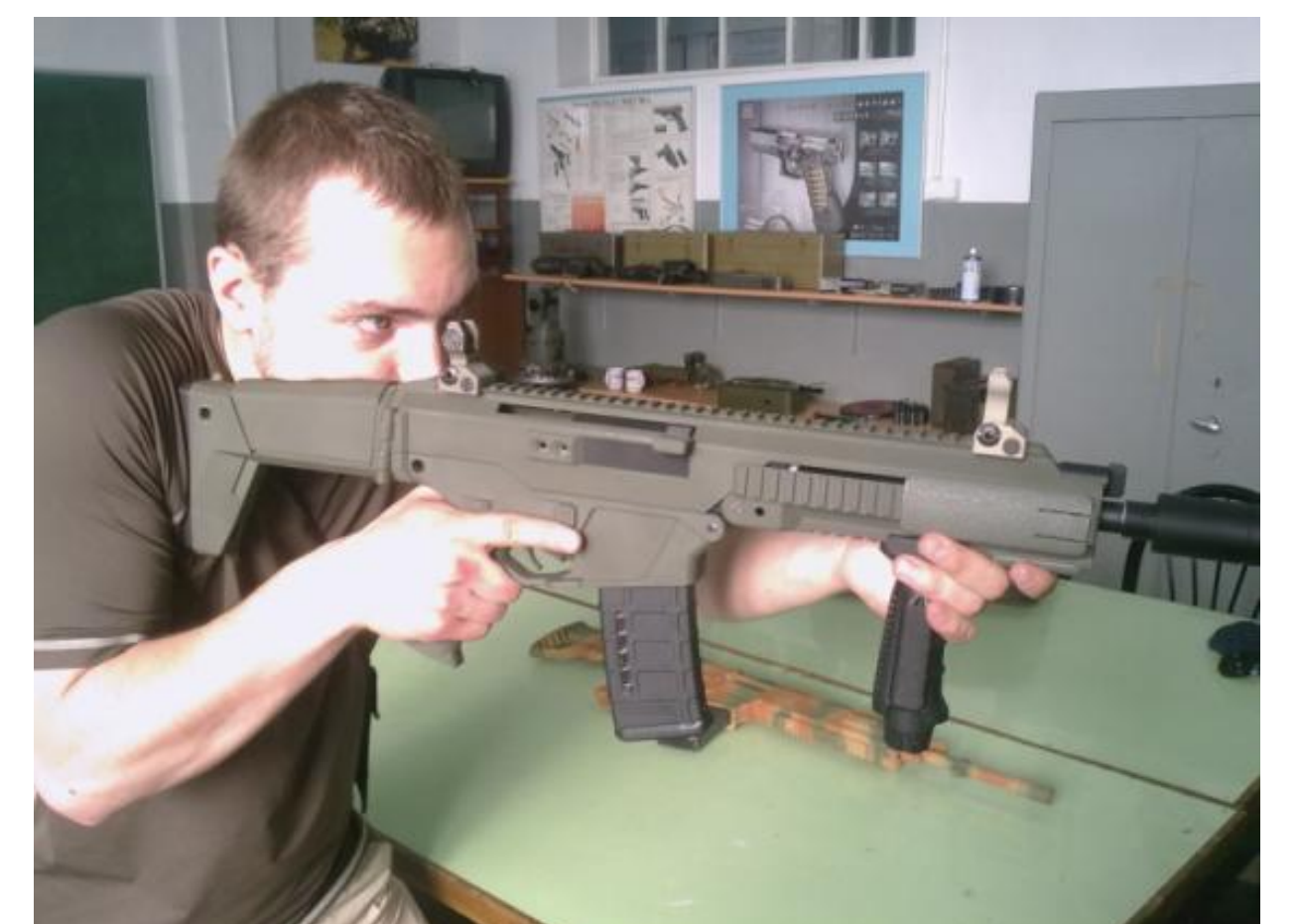
Weryfikacja zaproponowanych zmian konstrukcyjnych z wykorzystaniem makiet w postaci finalnej.
