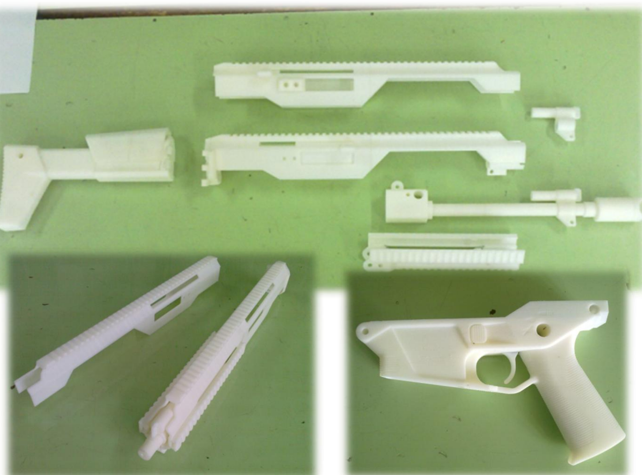
Opracowanie poszczególnych elementów makiet z wykorzystaniem metody FDM techniki szybkiego prototypowania
